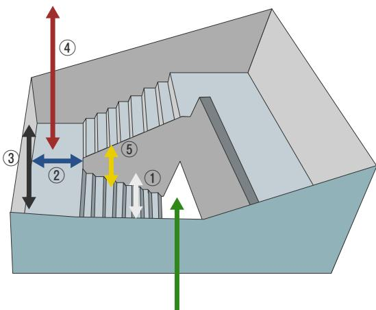
階段の入り口正面の奥行きが2200mmない場合はソファを立てるでの、階段入り口正面の天井高さが2392mm、階段入り口前のスペースが1090mm必要となります。(階段登りはじめすぐクランクがある場合はご相談下さい)
