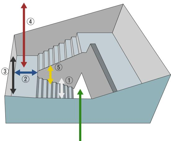
階段の入り口正面の奥行きが1830mmない場合はソファを立てるので、階段入り口正面の天井高さが2035mm、階段入り口前のスペースが1040mm必要となります。(階段登りはじめすぐクランクがある場合はご相談下さい)
